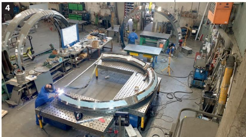
Alla base degli archi sono state saldate due piastre, sempre inox, dello spessore di 12 mm, con foratura a dima per poter installare gli archi sulle barre precedentemente annegate nei plinti.
