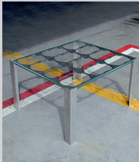
La griglia derivante dal taglio laser è di 10 mm di spessore, il vetro ultrachiaro appoggiato sul supporto inox ha uno spessore di 6 mm, mentre le “gambe” sono di altezza 459 mm, derivanti da un angolare (60x60x4 mm); l'acciaio inossidabile impiegato è EN 1.4301 (AISI 304).
