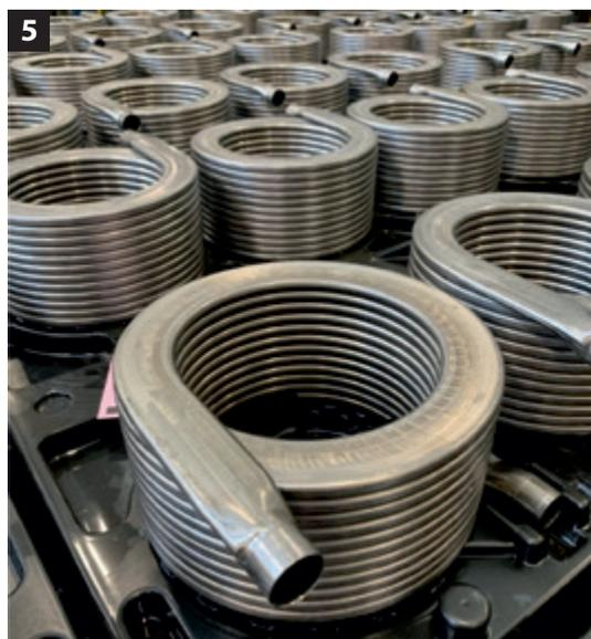
costituiscono lo scambiatore di calore a condensazione, schematizzato come cassa fumi stagna, all'interno della quale è alloggiata la serpentina e la camera di combustione, il prodotto è pronto per l'installazione all'interno della caldaia.
