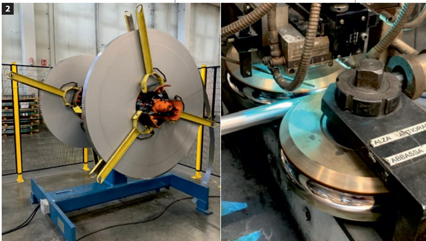
Si parte con un nastro come semilavorato, caratterizzato da uno spessore contenuto nell'intorno del millimetro, che viene srotolato e sottoposto ad una serie di passaggi di profilatura per ottenere un tubo, dal profilo circolare, di diametro nell'intorno di 1".
