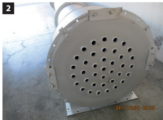
Fig. 3 Assieme del generatore di calore di tipo indiretto: cassa e tubi in AISI 304, camera di combustione in AISI 321
