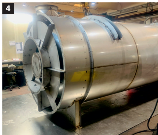
Fig. 4 Generatore di calore di tipo indiretto: particolare della cassa e della testata di estremità, in AISI 304
