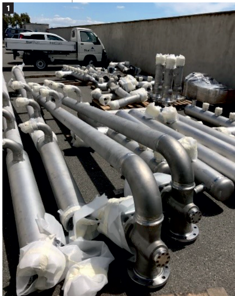
Fig. 1 Prodotti tubolari impiegati nell'impianto di osmosi inversa
