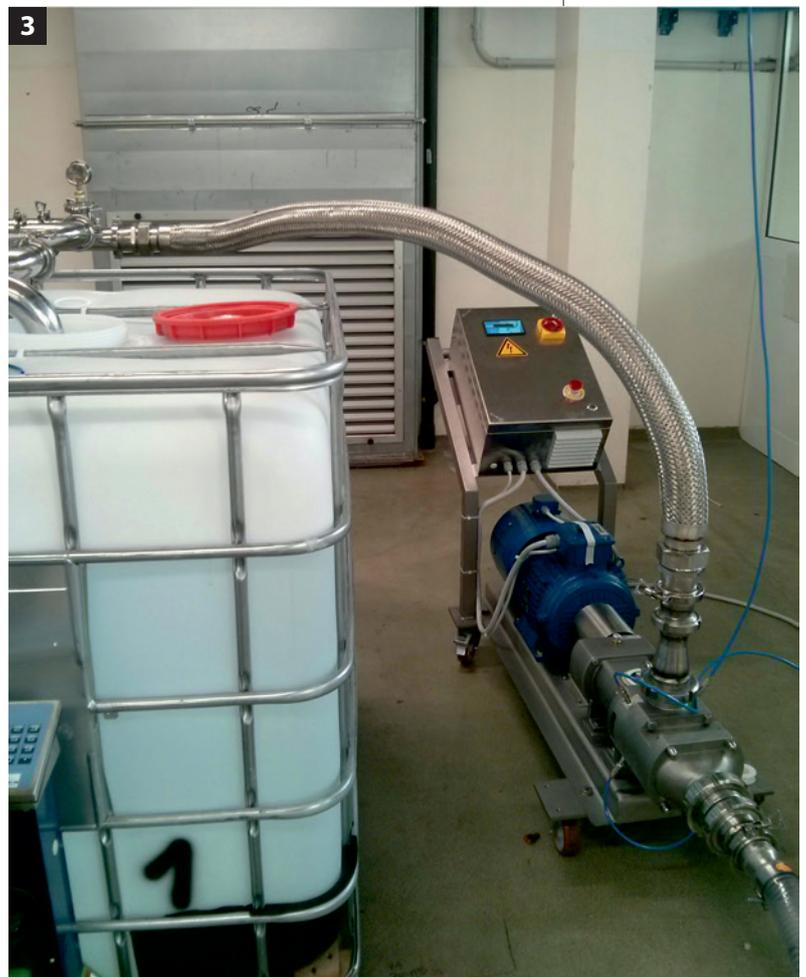
flussaggio statico delle tenute meccaniche, carenature sagomate e lucidate a specchio ottenute da lamiera in inox AISI 304 e carrelli per la movimentazione all'interno dello stabilimento produttivo in cui vengono installate.
