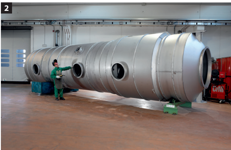
Fig. 2 vista d'insieme di uno scrubber
