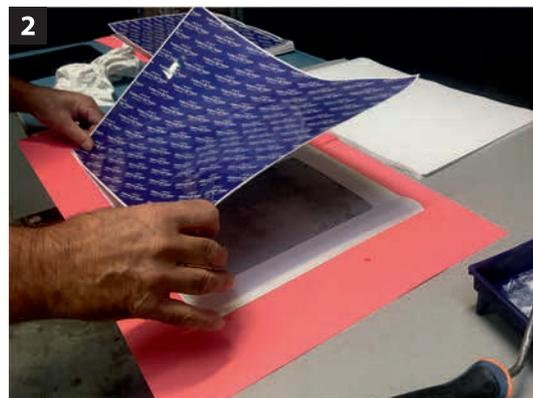
di aderire su tale componente, questo materiale deve avere determinate caratteristiche di ferromagnetismo, pertanto l'azienda è stata indirizzata verso un acciaio inox appartenente alla famiglia dei ferritici, sottoforma di lamierini aventi uno spessore di 0,4 mm e dimensioni di 20x23 cm e 20x17,5 cm.
