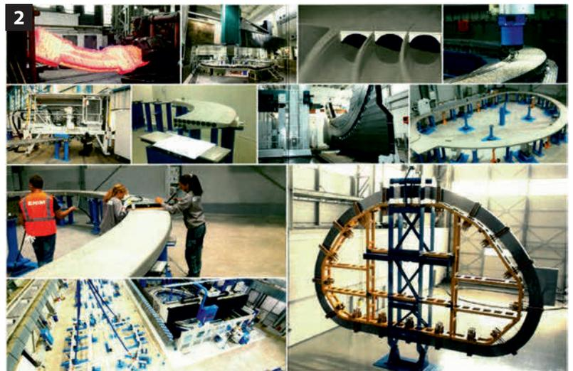
costruzione dei 70 radial plates fabbricati da due distinte società situate rispettivamente in Italia ed in Francia. I profili sono stati realizzati per laminazione a caldo e successiva trafilatura a freddo.
