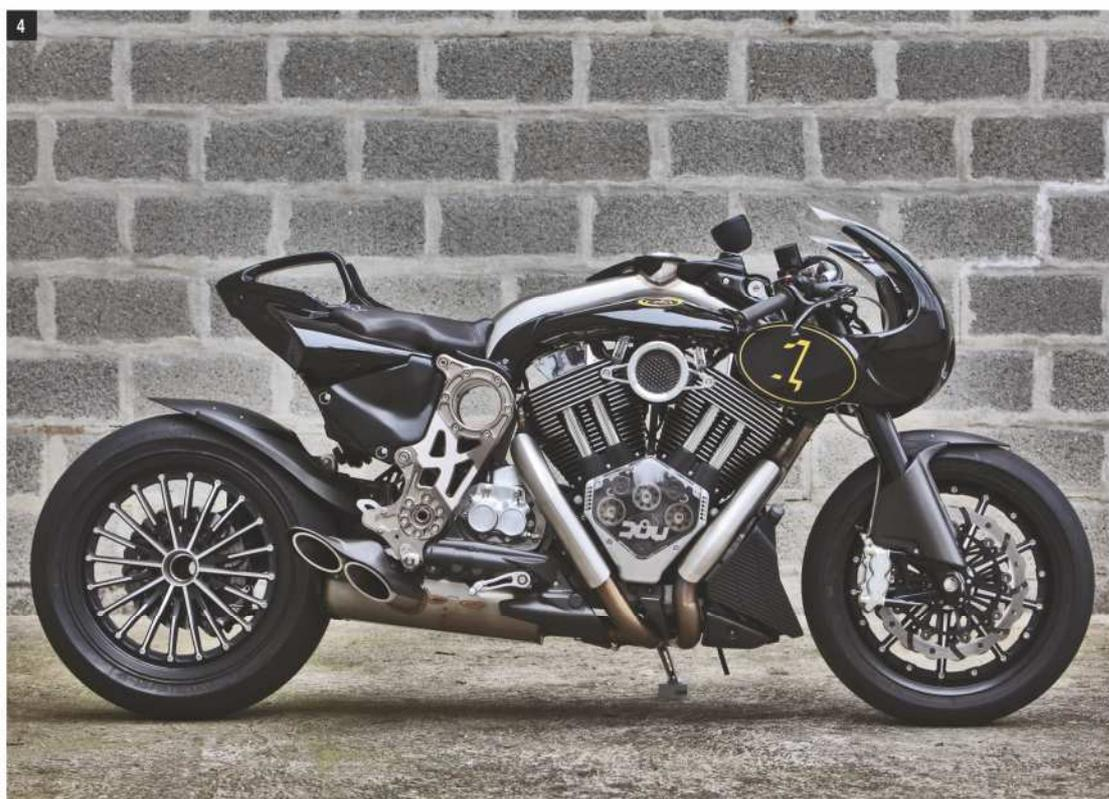
per un totale di 7,6 kg. Tutto l'insieme è completamente saldato manualmente in TIG.
