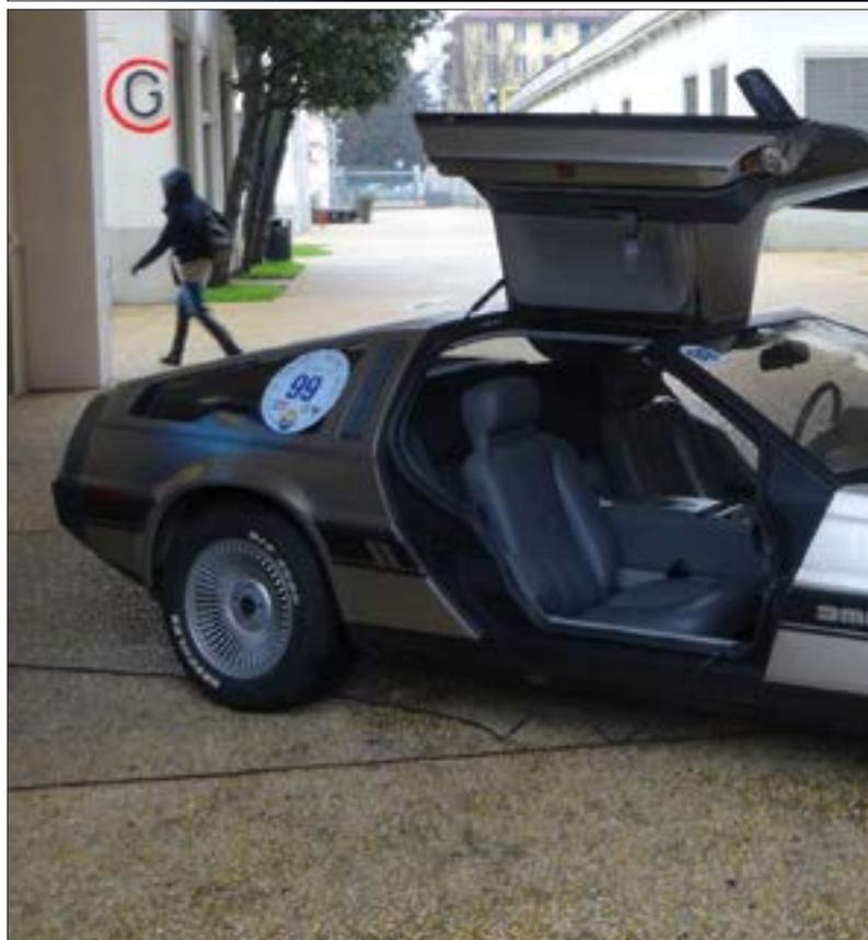
Fig. 3 – Queste e altre sezioni sono state stampate da lamiera in acciaio inox AISI 304.
