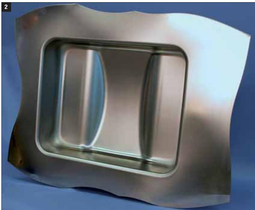
d'acqua, la pressione del fluido spinge la lamiera a copiare le forme della dima che costituisce lo stampo (**figg. 1, 2**).
