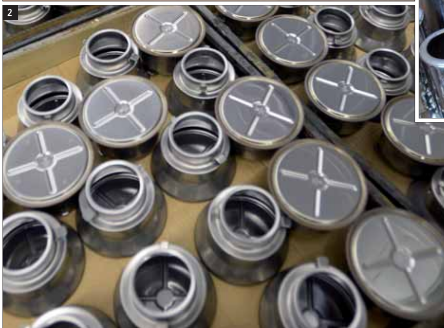
Figg. 1, 2, 3, 4 – Le varie fasi di imbutitura, partendo dal disco iniziale, per ottenere le due parti principali del prodotto finito.
