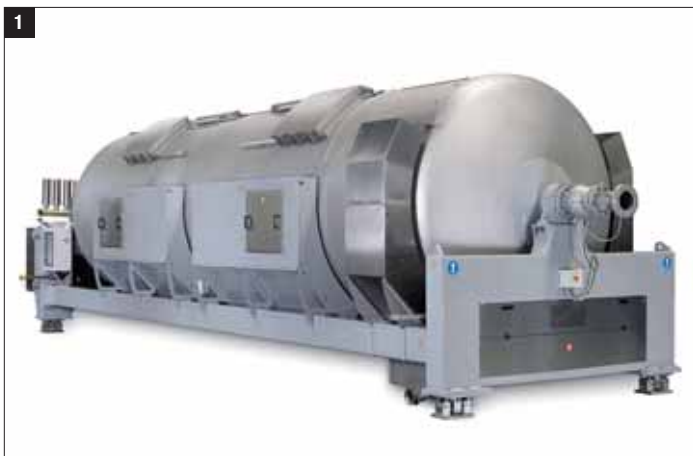
Figg. 1, 2 – L'impianto completo di una pressa a membrana prodotta dall'azienda oggetto dell'articolo. Gli spessori utilizzati variano, in funzione delle dimensioni dello stesso, per i fondi dai 3 ai 10 mm e per le virole dai 3 agli 8 mm.
