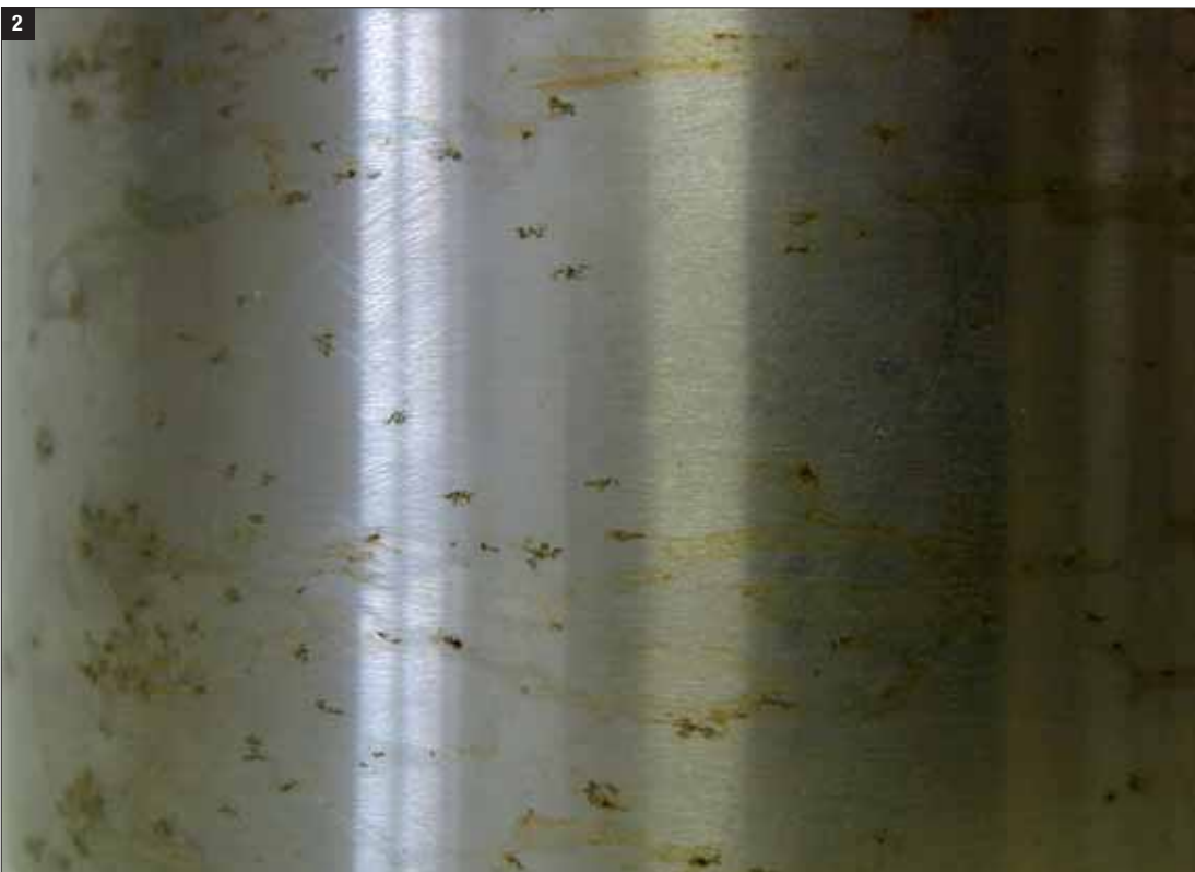
Figg. 2, 3, 4 – Esempio di corrosione per pitting (vaiolatura) con i dettagli del pit in vista frontale e in sezione.
