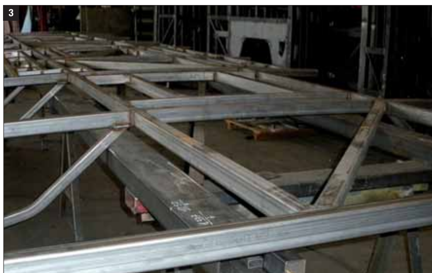
Fig. 2, 3 – Il telaio di questa nuova gamma di autobus può essere realizzato sia in acciaio al carbonio sia in acciaio inossidabile EN 1.4003, con un conseguente miglioramento di durata, sicurezza, comfort dinamico, consumi e capacità di carico, oltre che di limitazione dei cicli di protezione del metallo.
