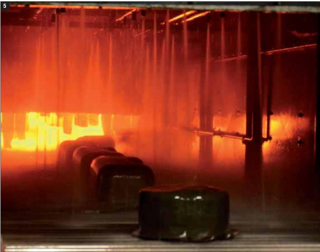
**Fig. 5** – Fase di raffreddamento del processo di ricottura di solubilizzazione.
