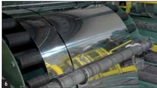
Fig. 5 – Linea di ricottura brillante (Bright Annealing).
