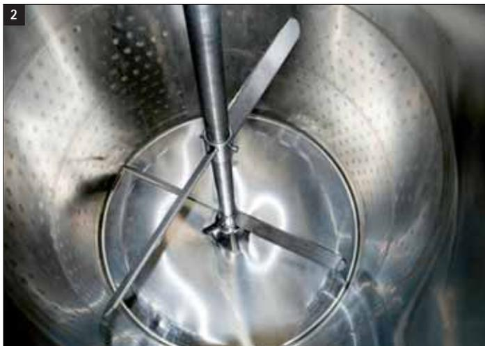
**Fig. 2** – Interno del serbatoio di ammostamento.
