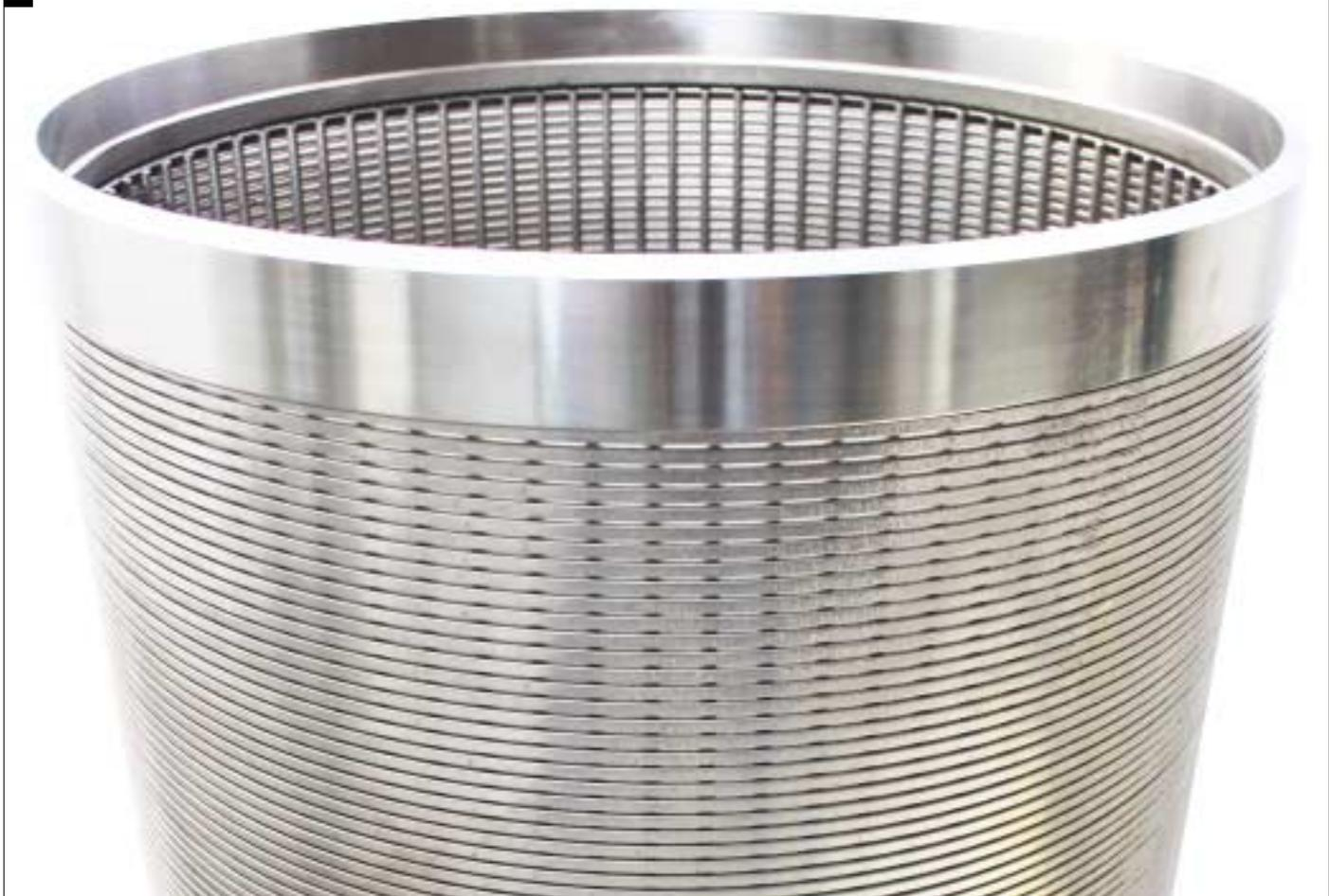
lunghezze desiderate. La disposizione, la dimensione e la forma delle fessure rispondono ai requisiti della norma DIN 4922. Il filtro a ponte garantisce una buona percentuale di area aperta ed è indicato per terreni con granulometria medio-grande.
