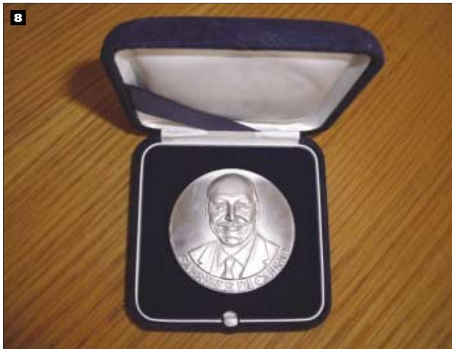
niatura definitiva, su pressa da 800 t con conio fronte/retro debitamente temprato, previo la preparazione del tondello che dovrà essere coniato. Questa preparazione comporta la tranciatura da lamiera, in acciaio inossidabile EN 1.4404 (AISI 316L), di un tondello avente diametro di 50 mm, con spessore 5 mm, a cui è seguito il processo di ricottura in forno con atmosfera controllata. La medaglia è così coniata (fig. 8).
