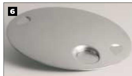
una pressa da 160 tonnellate, e la coniazione delle sedi delle valvole (fig. 6). Si ottiene così un coperchio del diametro di 245 mm e altezza 35 mm. L'altezza da ricavare però è di 24 mm e pertanto con l'ausilio di una bordatrice si riduce l'altezza alla misura voluta tramite un'operazione di tronatura. Per effetto di questa operazione si potrebbero formare delle bave di trancitura che vengono opportunamente eliminate, prima di pulire il pezzo con acqua e detergente nel
