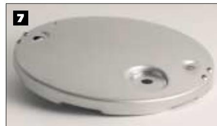
tunnel di lavaggio. Il lavaggio serve ad eliminare le polveri metalliche residue che potrebbero creare grippaggi nella fase di trancitura per creare i fori di alloggiamento delle valvole e delle viti di fissaggio del manico (fig. 7). Terminata questa lavorazione, eseguita con una pressa meccanica da 100 tonnellate, non resta che procedere alla coniazione delle alette a baionetta che contengono la guarnizione di tenuta e che servono per l'aggancio al corpo della pentola.
