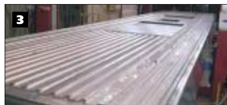
Fig. 3 - Particolare del tetto realizzato in 301LN.
