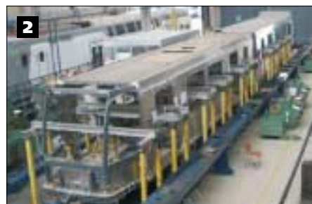
Fig. 2 - Una fase dei test q-statici eseguiti sul veicolo.
