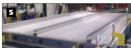
Fig. 5 - Particolare del telaio realizzato in 301LN 1/4 crudo.
