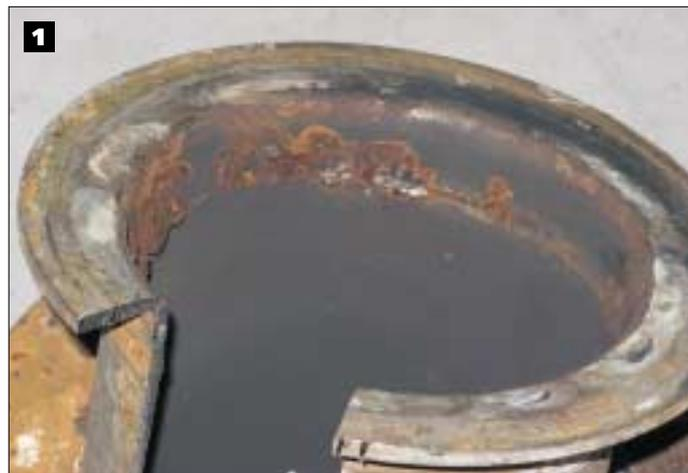
**Fig. 1 - Esempio di corrosione localizzata.**
