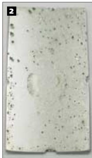
**Fig. 2 - Provino dopo un test di corrosione per pitting secondo ASTM G 48 met.A.**
