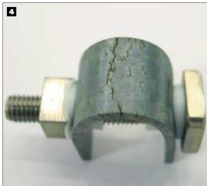
**Fig. 4 - Un provino che ha manifestato stress-corrosion-cracking.**
