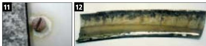
**Fig. 11** – Corrosione galvanica di vite in acciaio al carbonio su piastra in acciaio inox. **Fig. 12** – Risultato del fenomeno dell'ossidazione a caldo.
