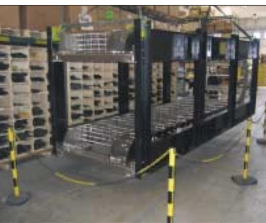
**Catena Est-Ovest, con struttura speciale di trasporto e sollevamento, per la piattaforma Statfjord B, corsa 10,2 m.**
