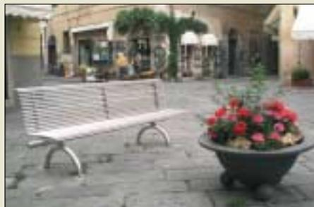
**Panchina modello "Rifle inox" in EN 1.4301 (AISI 304) costituita da tre spalle di supporto tagliate con laser, spessore 6 mm, collegate tra di loro da una barra orizzontale tubolare, diametro 60x2 mm, seduta e schienale composti da 29 profilati tubolari diametro 16x2 mm, chiusi alle estremità da tappi emisferici. Supporti di sostegno in tubolare diametro 48x2 mm sagomati ad arco. Viteria in acciaio inox.**
