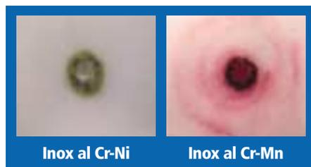
■ **REAGENTE MOLIBDENO ELETTROCHIMICO "DL12":** Kit per il Molibdeno elettrochimico ad alta affidabilità per tutte le leghe contenenti il Mo, compresi Hastelloy, tutti gli acciai inox e speciali. Utilizza due soluzioni e una batteria da 9V.
