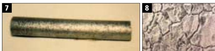
**Fig. 7** – Corrosione intergranulare su un tubo trattato termicamente in modo errato. **Fig. 8** – Dettaglio della tipica morfologia della corrosione intergranulare.
