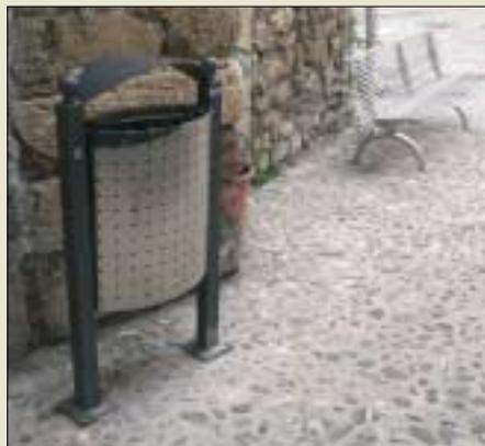
**Cestino gettarifiuti "Martino inox" con contenitore ellittico in AISI 304, spessore 1,5 mm, con fori quadri da 8 mm, decapato, passivato e satinato, basculante su supporti in tubolare quadro zincato e verniciato.**
