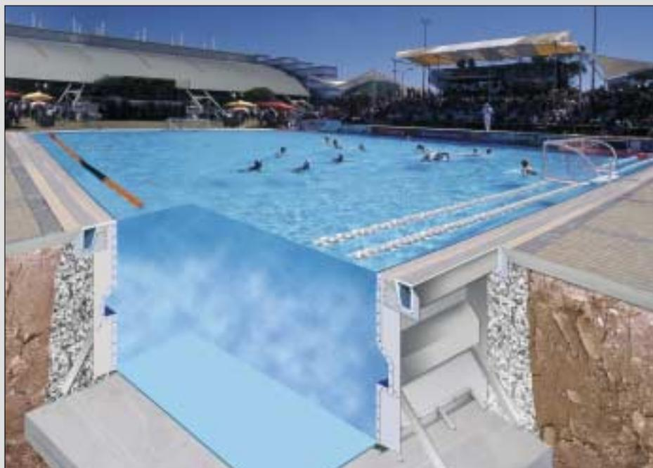
La Tecnologia Myrtha applicata ad una piscina di nuova costruzione, con la struttura portante in acciaio inox anziché in cemento.
