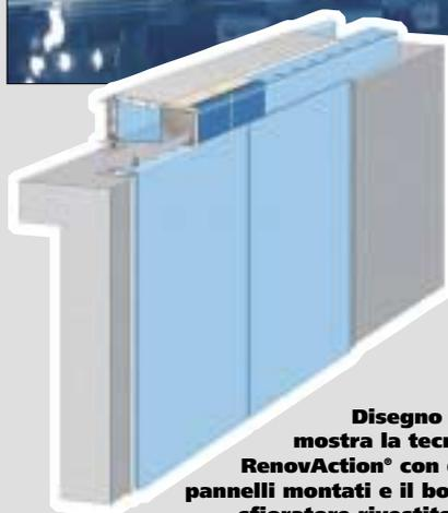
Disegno che mostra la tecnica RenovAction® con due pannelli montati e il bordo sfioratore rivestito da piastrelle in ceramica blu.
