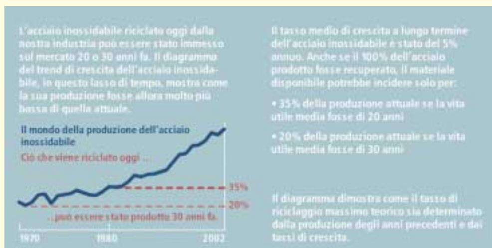
Fig. 2 - Con un contenuto medio del 25% di vecchi rottami, l'acciaio inossidabile si avvicina al contenuto massimo teorico di materiale proveniente da prodotti giunti al termine della loro vita utile.
