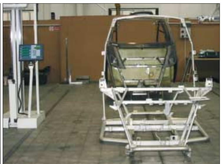
**Il telaio della "Maranello" è realizzato in tubolare di acciaio inossidabile EN 1.4301 (AISI 304), materiale che, oltre a consentire una struttura alleggerita, offre una buona capacità di assorbimento degli urti e ottime prestazioni in termini di rigidità torsionale.**
