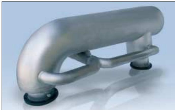
**Tubazioni di scarico di motori marini. È utilizzato acciaio inox EN 1.4301 (AISI 304) dove transita solamente il gas di scarico e EN 1.4404 (AISI 316L) nella zona di miscelazione del gas con acqua di mare (riser).**
