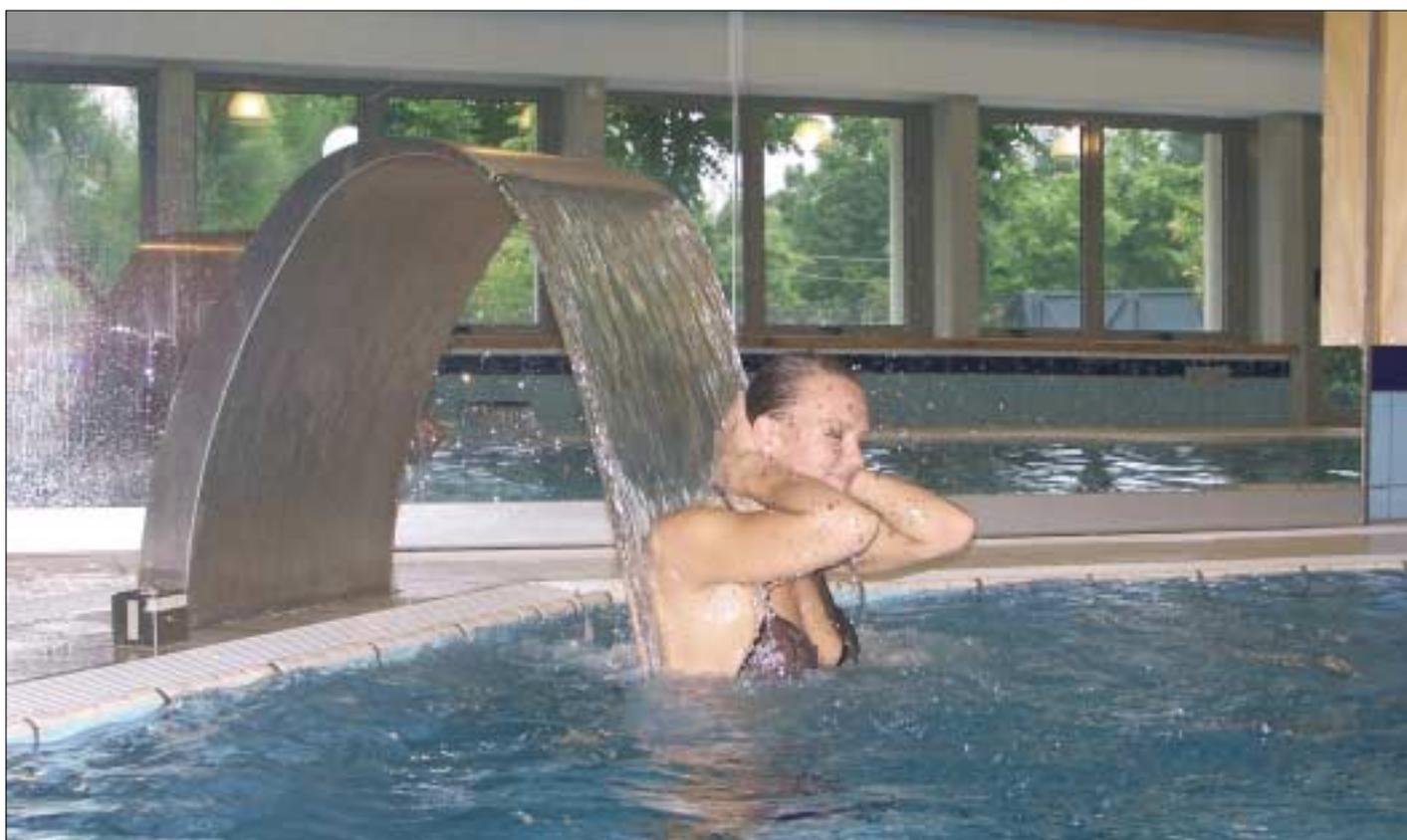
in acciaio inossidabile, materiale indispensabile per garantire l'igiene e la resistenza alla corrosione in ambienti densi di umidità, vapori caldi contenenti sostanze anche aggressive, detergenti e sanificanti.
