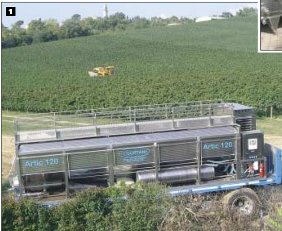
dotato di impianto frigo che, mantenendo l'omogeneo raffreddamento dell'uva in fase di raccolta, garantisce la stabilità delle caratteristiche e delle proprietà specifiche delle singole uve.
