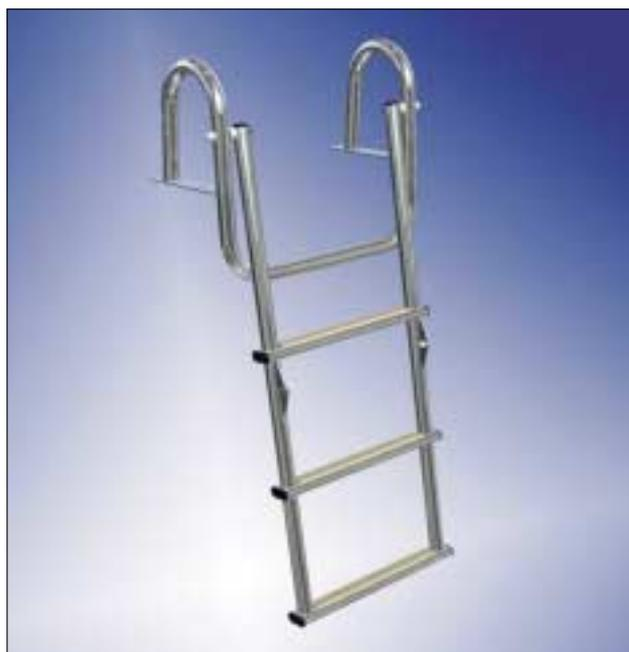
**Scaletta inox per applicazioni su plancia in vetroresina, costruita in tubo tondo, diametro 30 mm, e gradini in tubo ovale 50x20 mm, con inserto in legno iroko, completa di fermoscala e maniglie per facilitare la risalita dall’acqua.**
