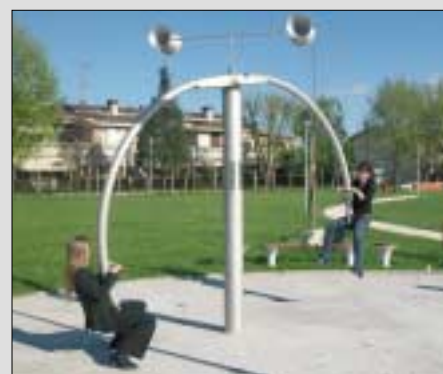
Questo strano dondolo ruota su se stesso oscillando piacevolmente. I tubolari inox che lo compongono hanno i seguenti diametri: 200 mm per la colonna di supporto, 90 mm per l'arco, 250 mm per gli elementi conici superiori e 22 mm per i tubi che li uniscono.
