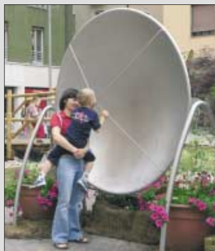
Due grandi parabole inox (di diametro 1.900 mm e spessore 3 mm) poste a distanza e il semplice bisbiglio di un bambino viene percepito chiaramente da un altro, posto davanti alla seconda parabola. I telai di sostegno sono in tubolare inox del diametro di 48 mm.
