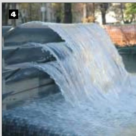
metro e il getto deve essere il più costante possibile per evitare imperfezioni. All'interno della lama è installato un tubo di  $\varnothing$  1", con una serie di fori lineari per una perfetta distribuzione dell'acqua. Nella parte anteriore "ugello" è realizzato un profilo a U presopiegato di lamiera forata inox, di spessore 1,5 mm, che evita la deformazione della lama.
