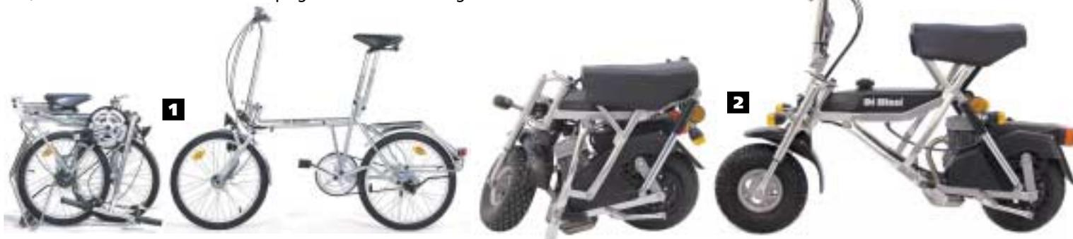
**Fig. 1 - Bicicletta inox modello R21 con pneumatici da 20", dimensioni: aperta, passo 93 cm, ripiegata 80x24x71 cm; peso 16 kg; ruote con raggi inox. Prodotta in altri due modelli R4 e R5 (più compatta quando è ripiegata) con pneumatici da 16". Fig. 2 - Ciclomotore pieghevole inox modello R7ES, velocità max 45 km/h, dimensioni: aperto passo 93 cm, chiuso 78x 37x61; massa vuoto 29,8 kg.**
