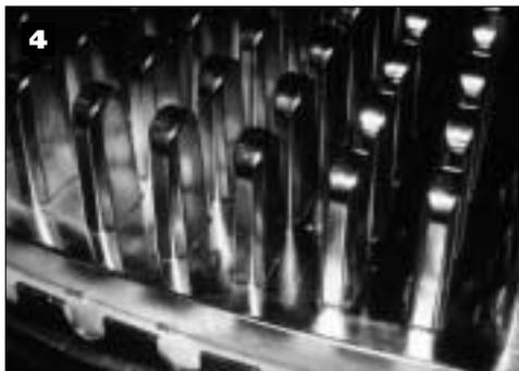
L'elettrolito necessario viene pompato attraverso un materiale isolante all'interno del quale risiede il catodo che è collegato ad un raddrizzatore portatile: l'elettropulitura si effettua passando avanti e indietro il tampone sulla zona da ripristinare, mentre l'elettrolita viene recuperato dal fondo del serbatoio e quindi ripompato sul catodo.
