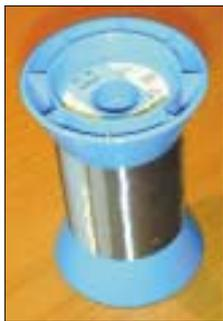
**Una bobina di sottilissimo filo inox EN 1.4404 (AISI 316L) del diametro di 0,035 mm.**
