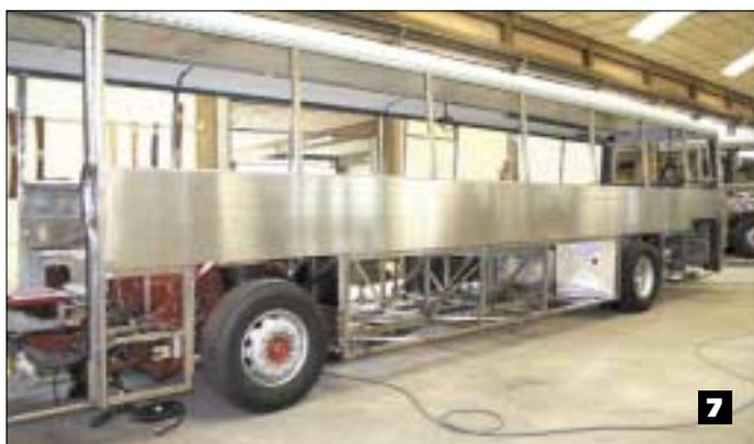
**Fig. 7 - Fase di completamento della lastratura con lamiera inox.**
