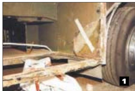
**Fig. 1 - Effetti della corrosione sui passi-ruota in acciaio al carbonio.**
