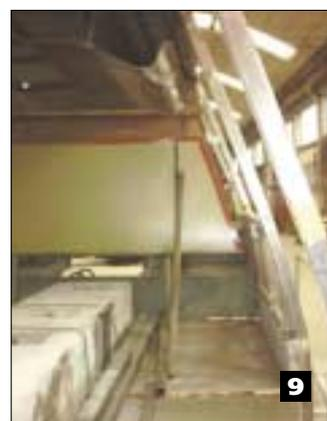
**Fig. 9 - Particolare che evidenzia come la piegatura della struttura inox non interferisca con la zona sedili dei passeggeri.**
