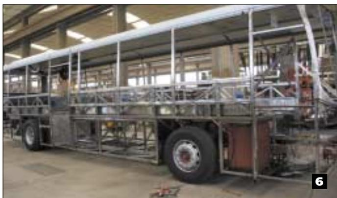
**Fig. 6 - La fase terminale dell'ossatura della struttura in tubolare inox.**
