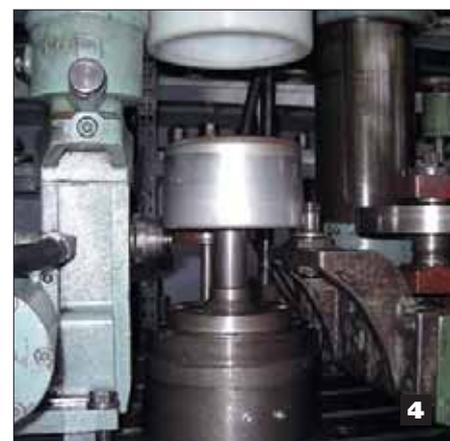
forma viene data mediante rulli preformati in acciaio temprato.
