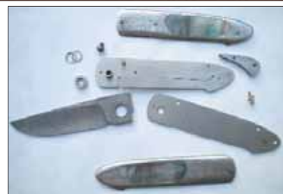
Fig. 2 e 3 - "Premium", prototipo di liner-lock con microcuscinetto a sfere schermato sul movimento della lama. Questa è in acciaio inox damascato, così come lo sono le guancette, con interframe in madreperla nera e liner in titanio.
