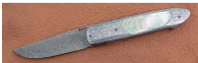
Fig. 2 e 3 - "Premium", prototipo di liner-lock con microcuscinetto a sfere schermato sul movimento della lama. Questa è in acciaio inox damascato, così come lo sono le guancette, con interframe in madreperla nera e liner in titanio.
