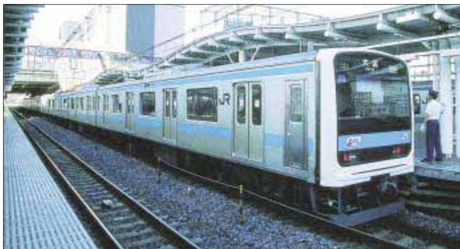
**Duplica il vantaggio dell'acciaio inox nella costruzione di carrozze ferroviarie: la diminuzione di peso con il conseguente risparmio energetico e la ridotta manutenzione ordinaria e straordinaria. Nella figura, un treno delle Ferrovie Giapponesi in UNS S30103 (Type 301L, ASTM A-240) (Foto: Japan Iron and Steel Federation).**
