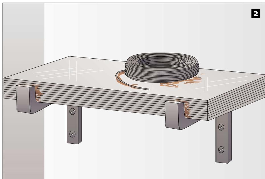
**Fig. 2 - Attenzione alle particelle di ferro che possono depositarsi in fase di stoccaggio del materiale.**
