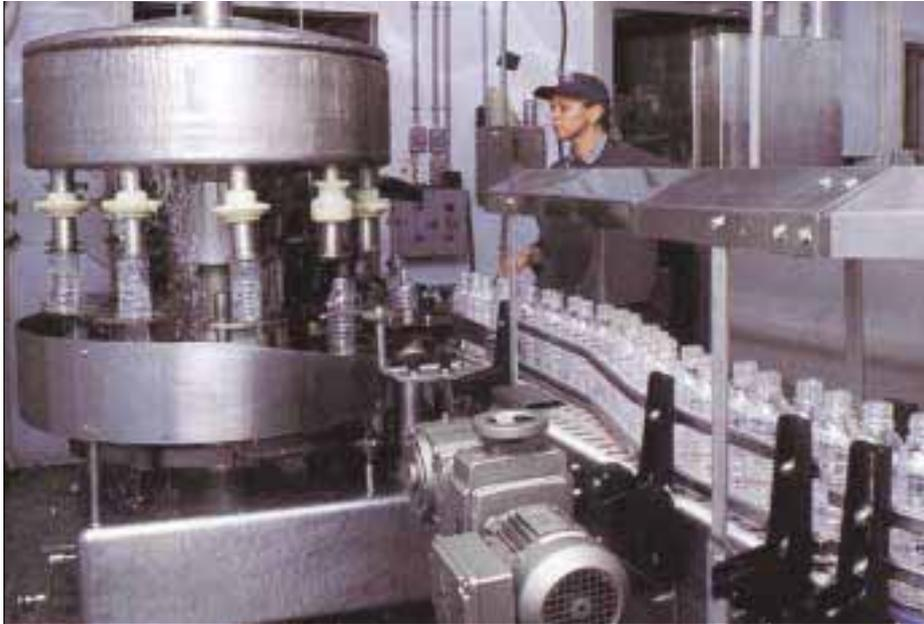
**L'inox (nei tipi EN 1.4401 - AISI 316 e EN 1.4301 - AISI 304) assicura massima igiene e resistenza ai trattamenti di sterilizzazione nell'industria dell'imbottigliamento (Foto: Nickel Institute).**
