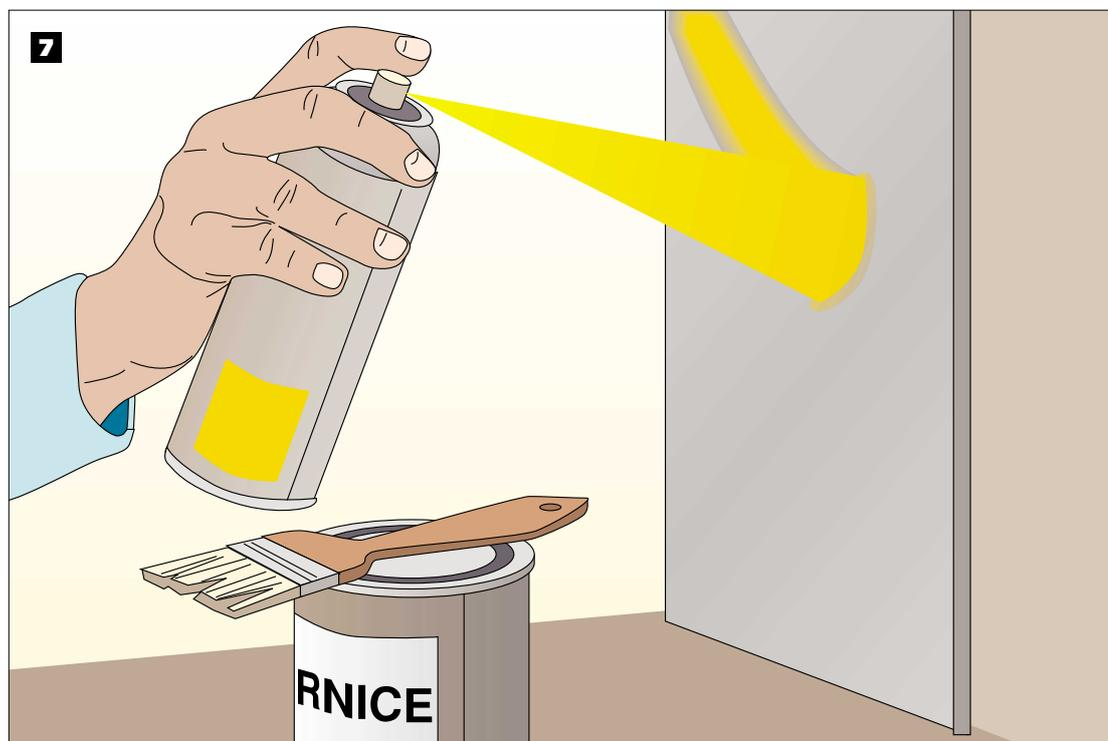
**Fig. 7** - Per la rimozione di vernice e graffiti è necessario utilizzare prodotti specifici, generalmente alcalini, o prodotti solventi svernicianti e poi risciacquare accuratamente con acqua calda (60°C).
