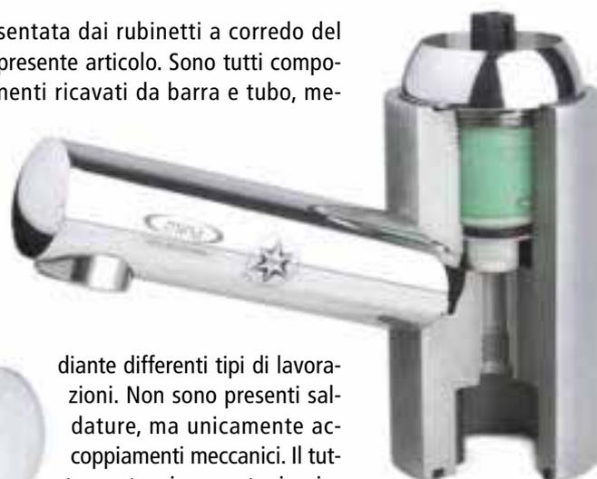
diante differenti tipi di lavorazioni. Non sono presenti saldature, ma unicamente accoppiamenti meccanici. Il tutto, cartuccia a parte, impiegando acciaio inox del tipo EN 1.4401 (AISI 316). Sempre per ciò che concerne la cartuccia, al fine di garantire la stessa durabilità del corpo del rubinetto, le astine originali in ottone vengono sostituite da astine in inox.
