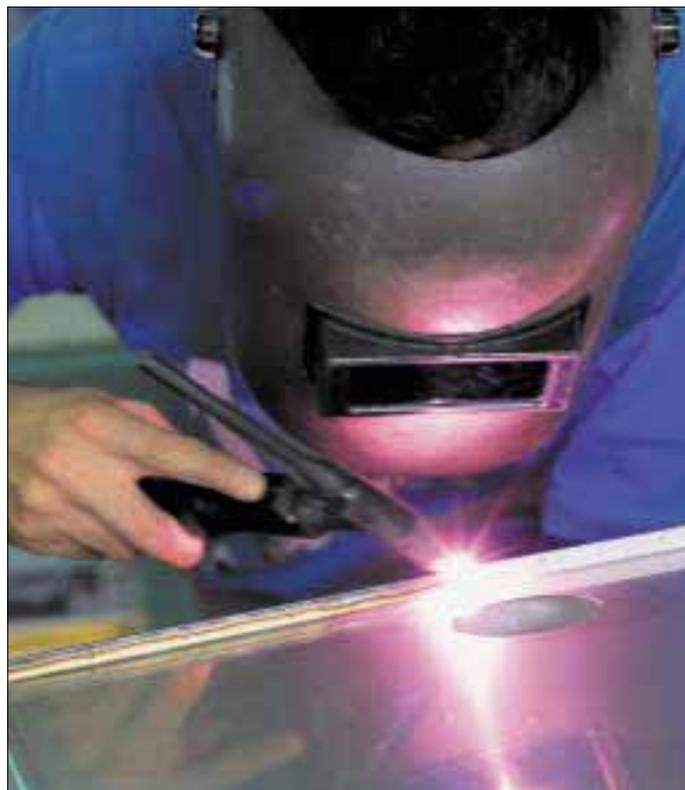
**L'assemblaggio dei componenti avviene a mezzo saldatura con tecnica micro-plasma.**
