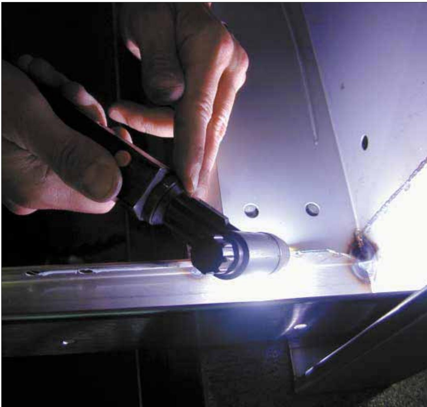
**Con la tecnica del micro-plasma è possibile saldare i componenti di piccolo spessore e in posizioni di difficile accesso.**
