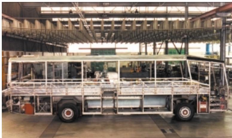
6) Sopra le scocche autoportanti costruite con tubi quadri in EN 1.4301 (AISI 304)
