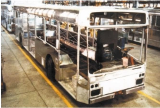
5) A lato un esempio di applicazione strutturale dell'acciaio inossidabile
