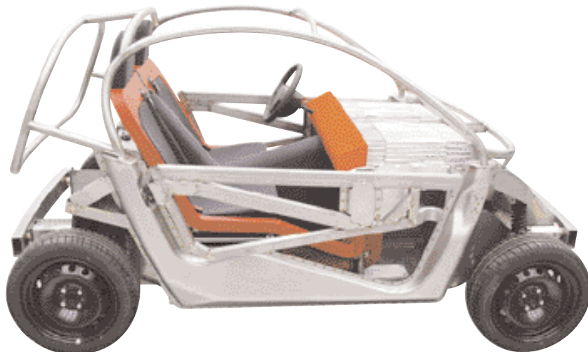
Fig. 1 La struttura della Nido (in alto), interamente in acciaio inox EN 1.4301 (AISI 304), e la ripartizione delle masse in caso di urto (in basso).
