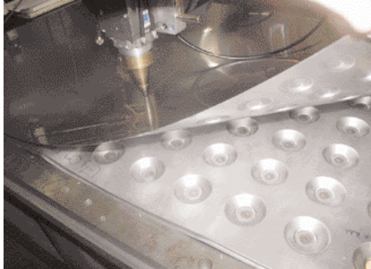
Fig. 5 Dettagli relativi alle saldature laser ampiamente impiegate in fase di assemblaggio
