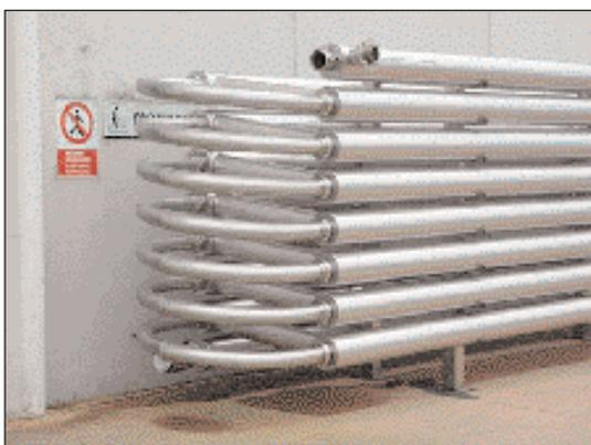
**Fig. 3** Scambiatore di calore per pigiato d'uva per l'industria alimentare realizzato in AISI 304.
