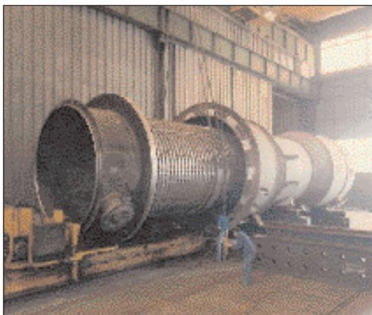
**Fig. 2** Scambiatore di calore verticale in AISI 304.
