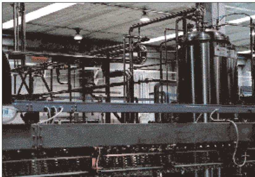
Fig. 8 Particolare di un impianto di imbottigliamento di acqua minerale: sono visibili i numerosi tubi lucidati di acciaio inossidabile AISI 304.
