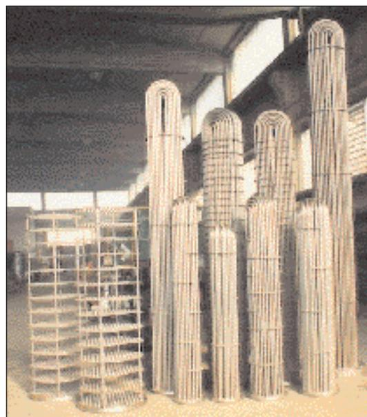
Fig. 9 Condensatori e raffreddatori di liquido destinati all'industria chimica.
