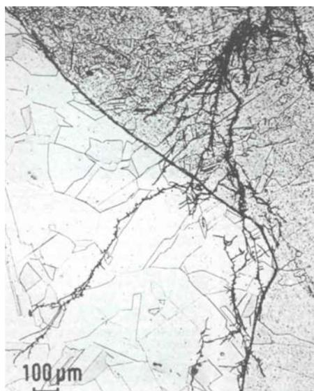
**Figura 9: stress corrosion cracking in un giunto saldato. L'andamento della cricca è transgranulare.**
