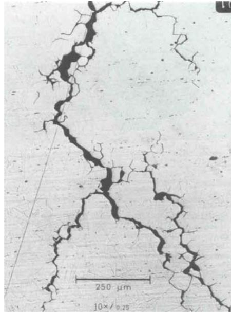
Figura 10: stress corrosion cracking in un giunto saldato. L'andamento della cricca è intergranulare.
