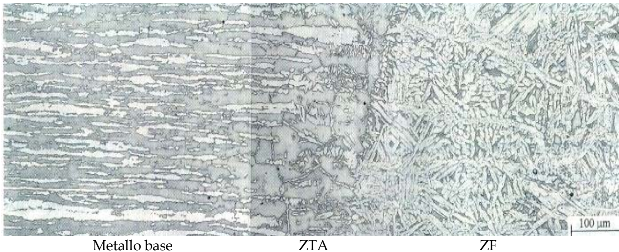
Figura 6: Aspetto microstrutturale tipico di un cordone di saldatura in acciaio inossidabile bifasico, realizzato con tecnologia TIG.
