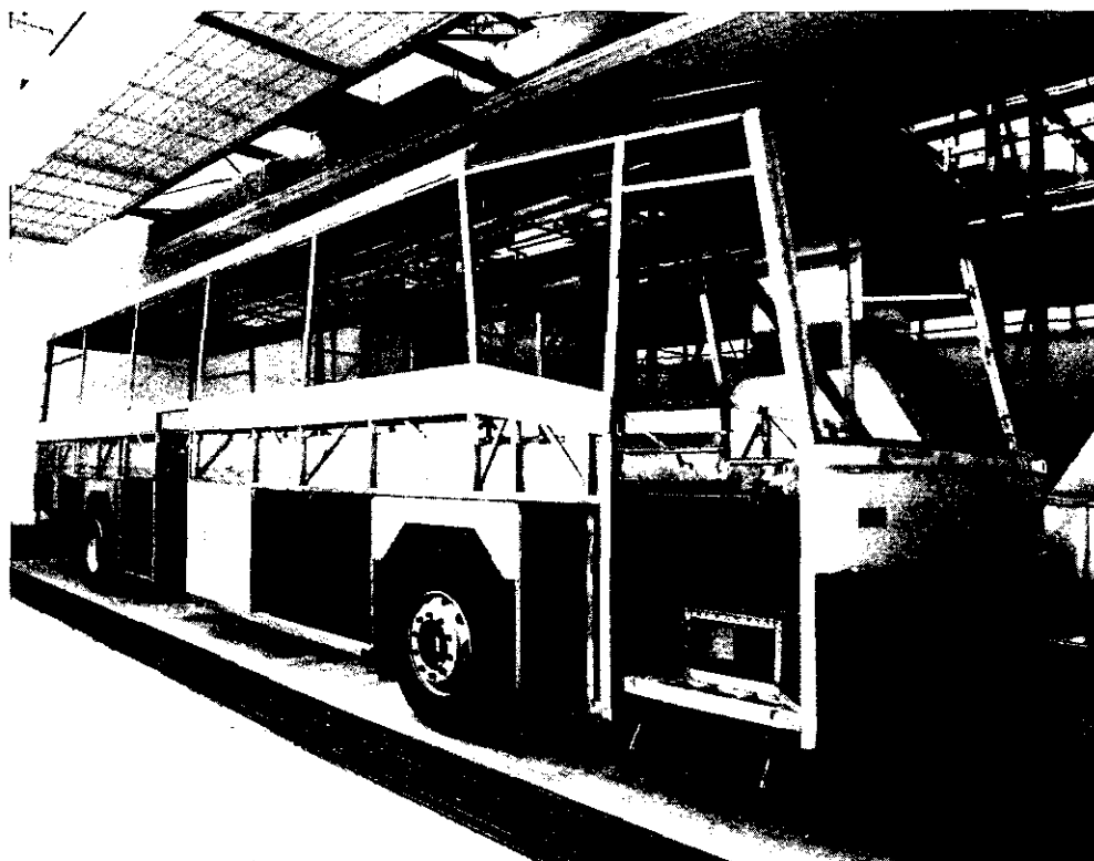
Scocca realizzata interamente con tubi saldati inox a sezione quadrata e rettangolare per l'autobus "Rosso Modena". Costruzione: Officine Padane, Modena.
