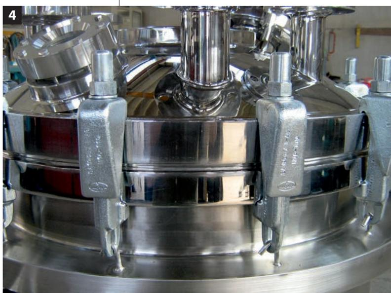
ancora con pale raschianti in PTFE e montati su telaio skid per la relativa costruzione dell'impianto. I due mescolatori dovranno operare a contatto con soluzioni aventi una certa frazione alcolica, necessarie per la produzione di prodotti cosmetici quali, per esempio, creme ed acque micellari.
