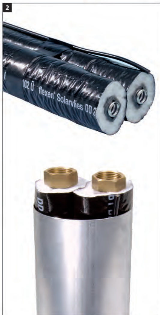
Fig. 2 "Tubo Solar" è composto da due tubi in AISI 304, disponibili con diversi diametri e lunghezze. I due tubi corrugati in acciaio inox (mandata e ritorno acqua) sono completamente preisolati. Il particolare isolamento composto da 100% di vello poliestere consente una ridotta dispersione del calore dovuta a una bassa conducibilità termica.
