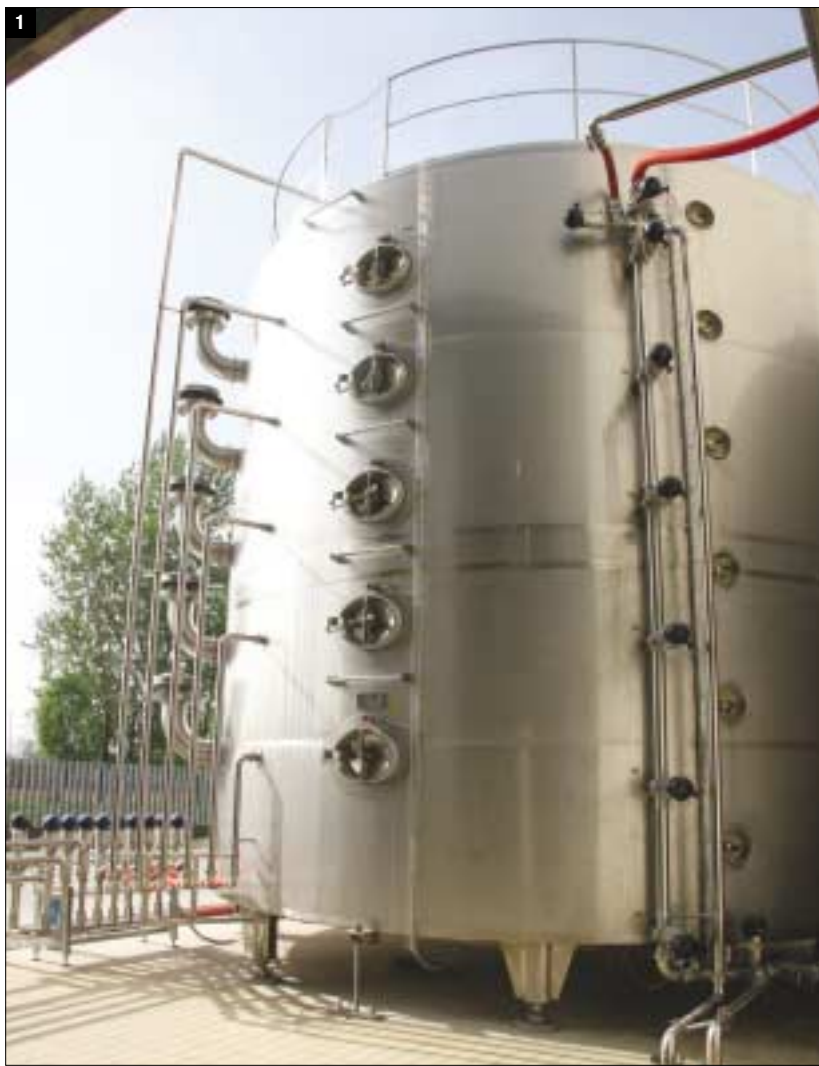
Fig. 1 - Il peso di un affioratore è di circa 17.000 kg.
