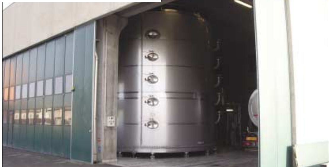
Fig. 1 - Il peso di un affioratore è di circa 17.000 kg.
