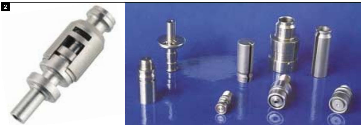
Fig. 2 – Le elettrovalvole sono un esempio della duplice natura degli acciai inossidabili in termini di proprietà magnetiche: acciaio inossidabile ferritico (ferromagnetico) e austenitico (non-ferromagnetico) in abbinamento per il corretto funzionamento di un componente di grande responsabilità.
