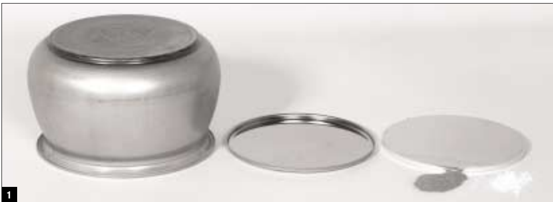
Fig. 1 – Elementi costitutivi di una pentola con fondo termodiffusore: corpo pentola in acciaio inox, fondello in alluminio e rivestimento inox del fondello in alluminio.
