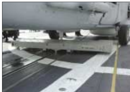
Fig. 3 - Elicottero bloccato dalla piattaforma RSD del sistema ASIST e pronto per essere guidato nell'hangar utilizzando il tracciato monorotaia.
