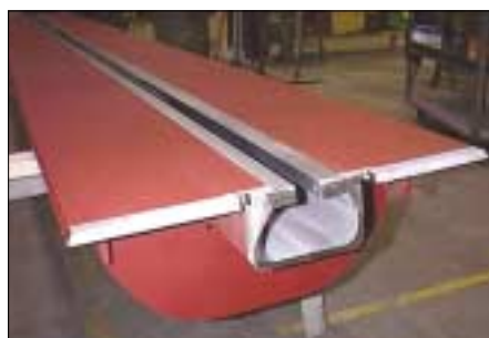
Fig. 4 - LWT in sezione trasversale con rotaia composta dai due profili estrusi e saldati al piano del ponte.
