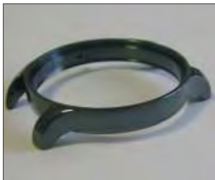
Una cassa da orologio in acciaio inox, dopo il trattamento protettivo DLC (Diamond-Like Carbon).
