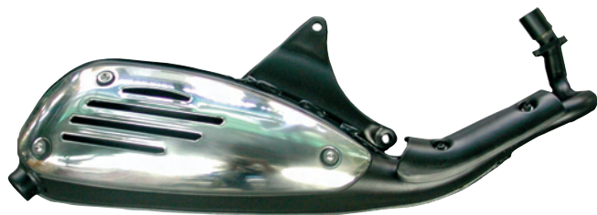
L'esterno della marmitta con componenti in acciaio inox ferritico EN 1.4512 (AISI 409).
