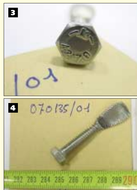
Fig. 3 e 4 - La vite marcata A2 cui dovrebbe corrispondere, secondo la norma internazionale UNI EN ISO 3506, un acciaio inox austenitico della serie 300 al Cr-Ni, che analisi di laboratorio (vedi Tabella 1) hanno rivelato essere un materiale al cromo-manganese.
