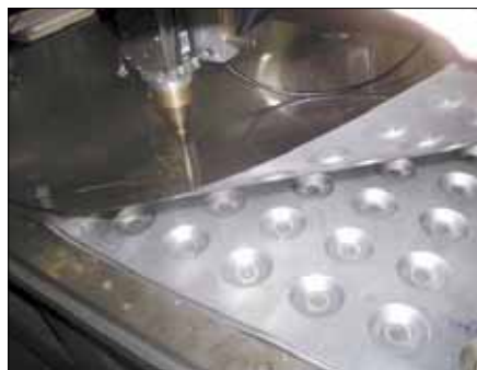
Dettagli relativi alle saldature laser impiegate in fase di assemblaggio.
