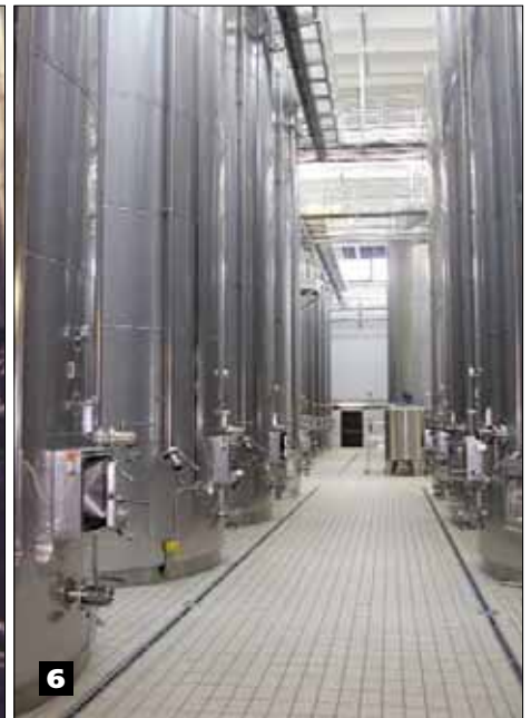
Fig. 3 e 4 - Cantina di prima fermentazione spumanti costituita da 15 serbatoi, da 600 hl, in acciaio inox EN 1.4301 (AISI 304), con ultima virola e tetto in EN 1.4401 (AISI 316). Anche la scala a rampe, autoportante, e le passerelle di collegamento sono realizzate completamente in acciaio inox EN 1.4301 (AISI 304).
