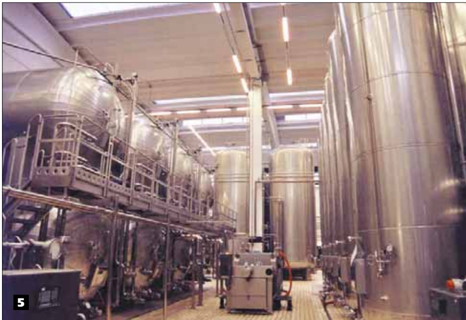
Fig. 5 e 6 - Isolamento con rivestimento inox di autoclavi orizzontali e verticali.
