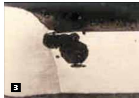
Fig. 3 - Un esempio di fenomeno corrosivo innesco sotto l'ossido di saldatura.
