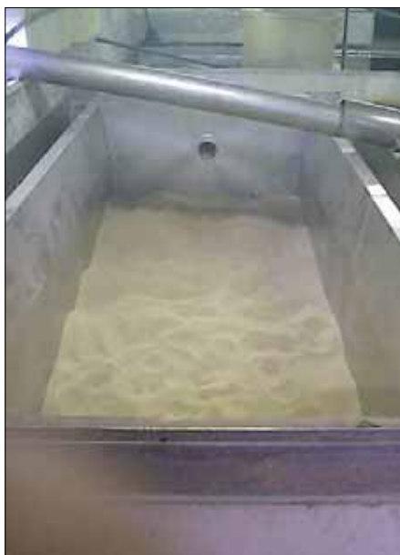
Vasca di caricamento della sabbia.
