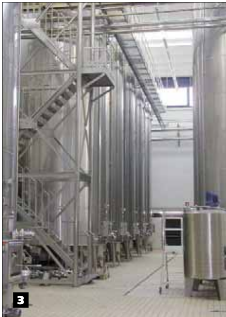
Fig. 3 e 4 - Cantina di prima fermentazione spumanti costituita da 15 serbatoi, da 600 hl, in acciaio inox EN 1.4301 (AISI 304), con ultima virola e tetto in EN 1.4401 (AISI 316). Anche la scala a rampe, autoportante, e le passerelle di collegamento sono realizzate completamente in acciaio inox EN 1.4301 (AISI 304).
