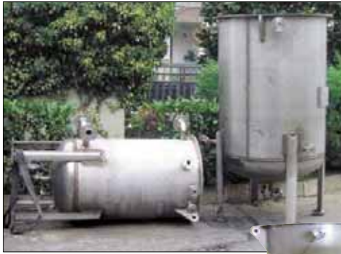
Fig. 4 – A sinistra, due serbatoi per industria chimica prima dell'operazione di decapaggio: sono visibili gli ossidi lungo i cordoni di saldatura. A destra i serbatoi dopo il decapaggio chimico (immagini per cortesia della ditta Delmet di Gorgonzola MI).
