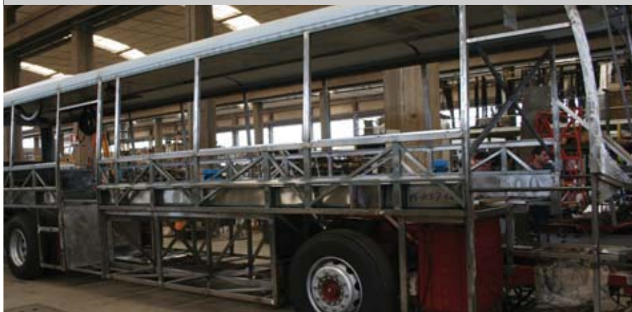
La struttura tubolare portante di acciaio inossidabile Stainless steel tubular bearing structure
