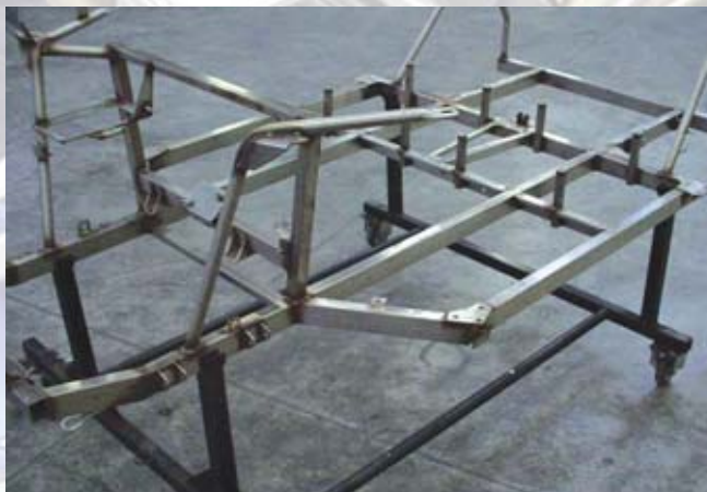
Il telaio in tubolare di acciaio inox AISI 304 di un quadriciclo leggero AISI 304 stainless steel tubular frame of a light four-wheel vehicle
