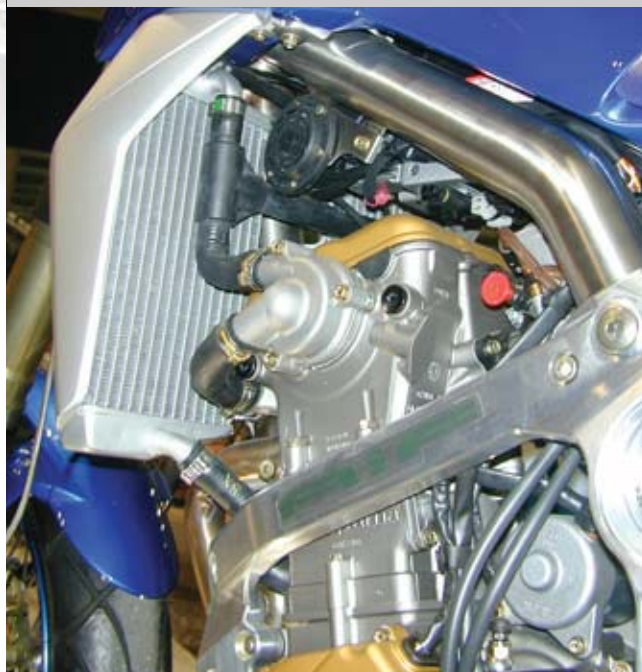
Particolare della struttura tubolare di acciaio inossidabile del telaio STR 650 A detail of the stainless-steel tubular structure of the frame of the STR 650
