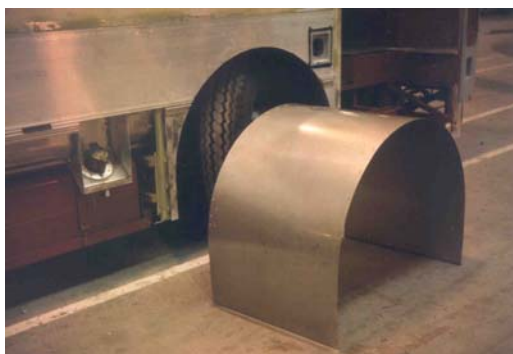
Figura 6: Acciaio inox per i passaruota.
