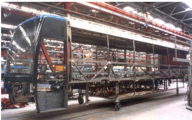
Figura 5: testate, padiglione e traliccio dopo l'assemblamento.
