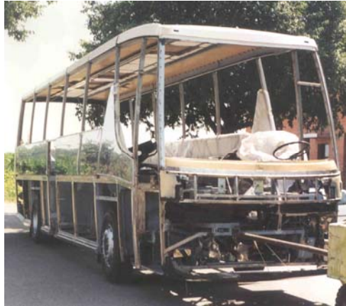
Figura 2a: la struttura di un autobus turistico moderno (Eurobus – MO).
