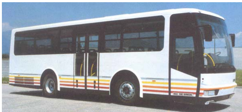
Figura 3a: autobus inter-city a struttura autoportante (De Simon - Osoppo UD)
