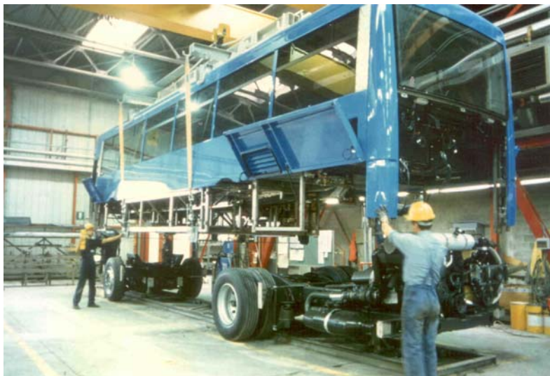
Figura 7: la fase finale di posizionamento sullo chassis.
